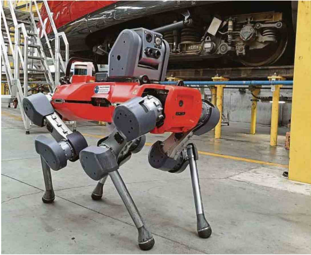
Alstom a développé un « chien-robot », bardé de capteurs, caméras et dressé à l'intelligence artificielle qui passe dans les hangars, se glisse sous les rames, et peut flairer les anomalies techniques.
