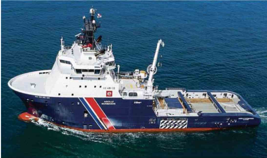
Le navire est l'un des plus puissants remorqueurs d'assistance au monde, avec ses 22.000 CV et une capacité de traction de 280 tonnes. Photo Abeilles International
